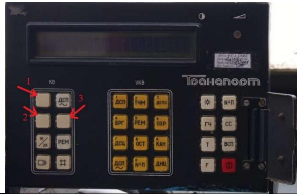
Установите порядок расположения функциональных кнопок на пульте управления радиостанцией на КВ диапазоне
