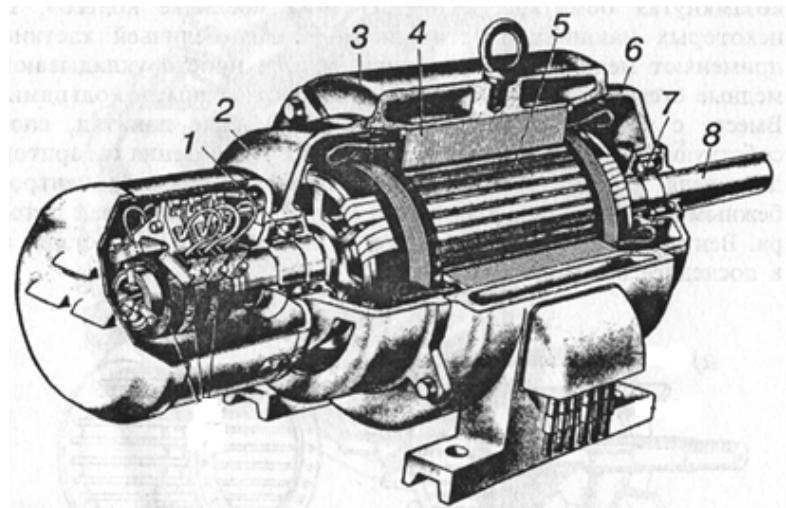
Определите соответствие между частями трехфазного асинхронного двигателя:
