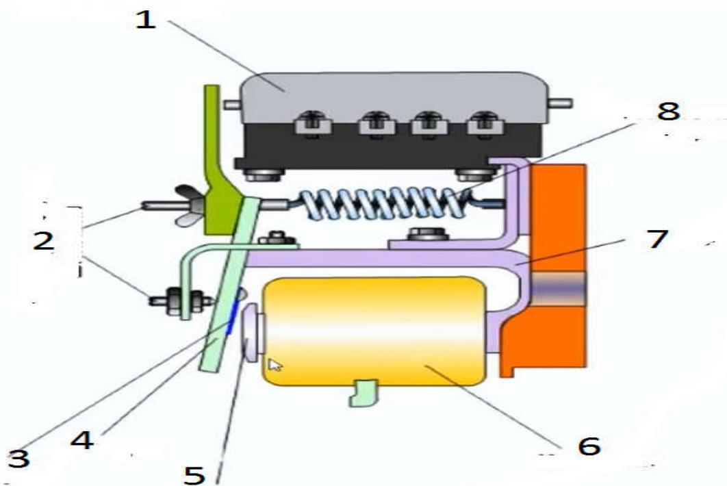
Определите соответствие между частями промежуточного реле
