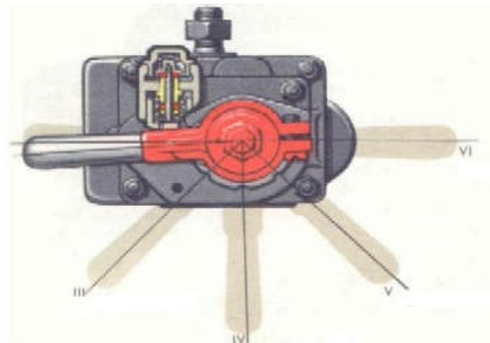
Привести давление в ТЦ при определенных положениях ручки крана вспомогательного тормоза в кгс/см<sup>2</sup>
