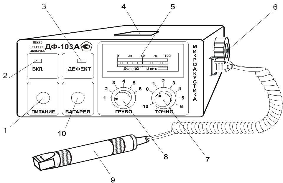
Определите соответствие кнопок управления на приборной панели дефектоскоп-градиентометр ДФ-103.
