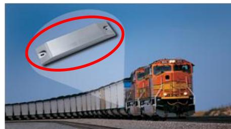
48. АСКОПВ включает в себя \_\_\_\_\_, которые предназначены для бесконтактного контроля соблюдения габарита погрузки погруженных на открытый подвижной состав грузов, счета вагонов от головы состава, определения скорости движения состава в процессе движения (выделены на рисунке красным цветом).
