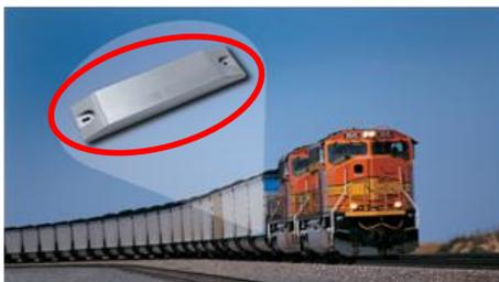
48. АСКОПВ включает в себя \_\_\_\_\_, которые предназначены для бесконтактного контроля соблюдения габарита погрузки погруженных на открытый подвижной состав грузов, счета вагонов от головы состава, определения скорости движения состава в процессе движения (выделены на рисунке красным цветом).
